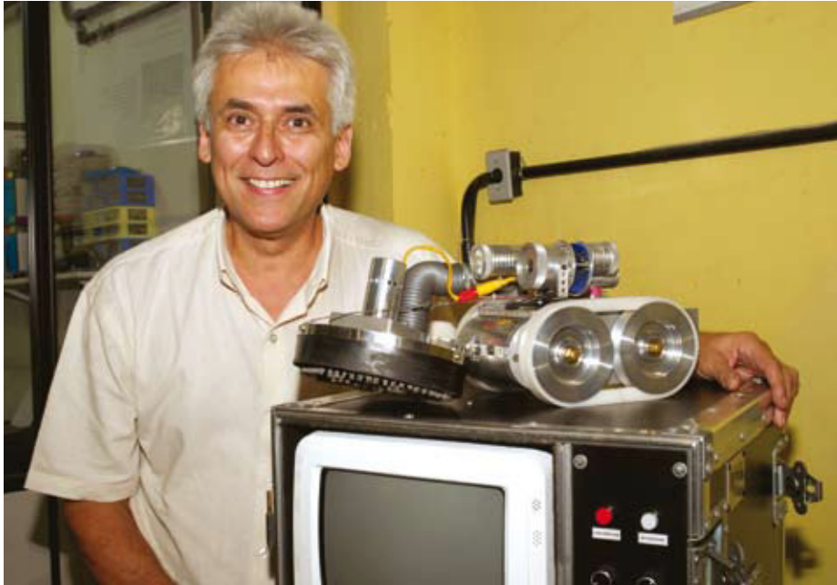
▲ Alexandre Etchebehere mostra o inovador robô multiferramenta capaz de limpar e higienizar dutos do sistema de ar-refrigerado
