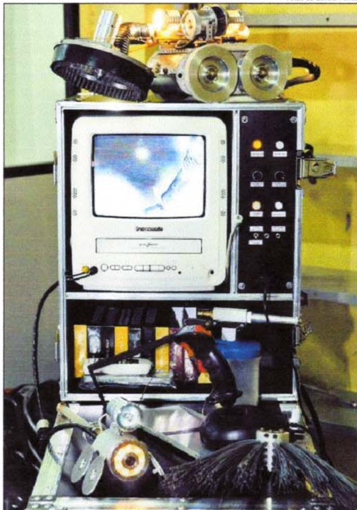
■ O ROBÔ-IN e suas múltiplas ferramentas para a limpeza de dutos de ar-condicionado sobre o monitor que serve como guia para o usuário
